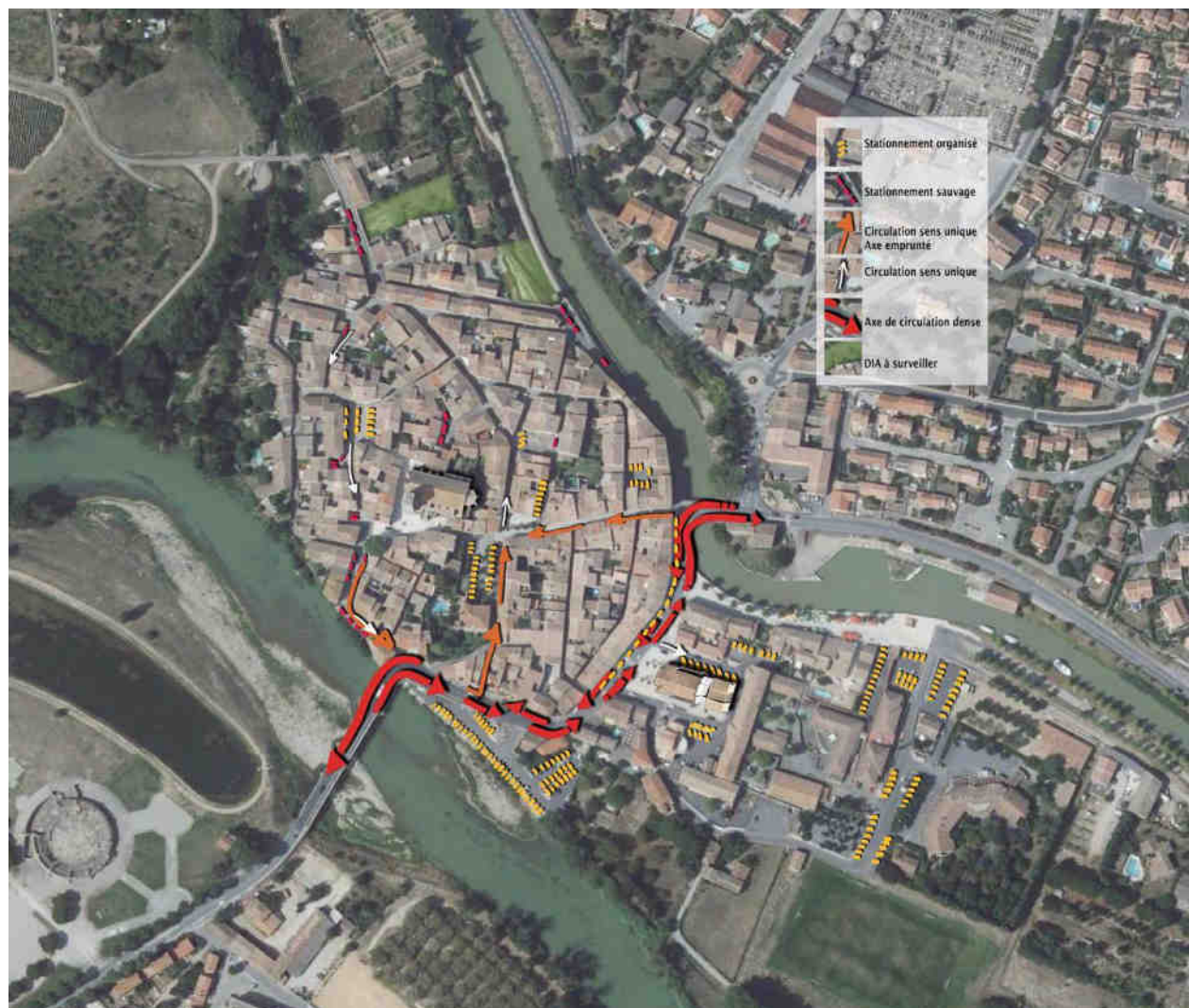
Figure 35 : Cheminements, circulations et stationnement dans le centre ancien de Trèbes, source : Diagnostic Pré-OPAH Trèbes, réalisation : Urbanis, 2022.
